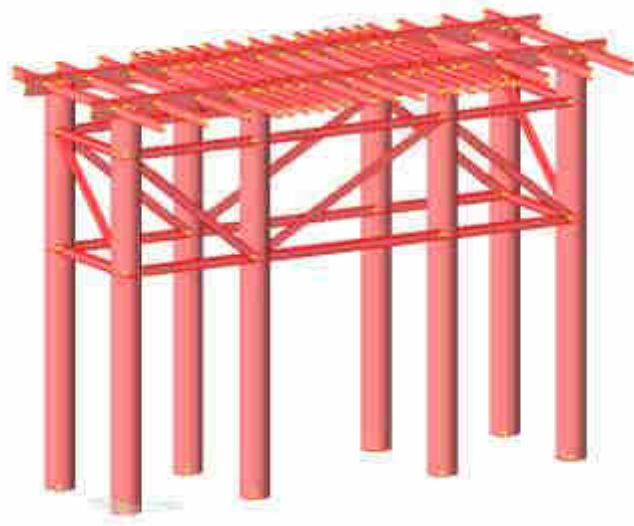
图 4 支架有限元模型图
