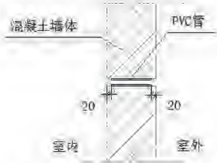
第一步：剔除PVC管，剔凿深度为20mm
